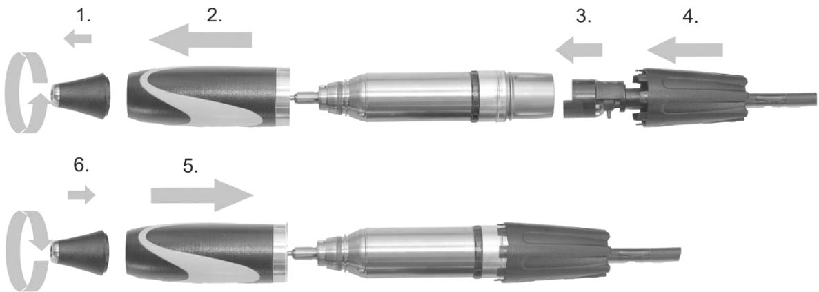
3. Beim Einstecken des Kabels in den Akku, den Markierungsstrich auf dem Steckkörper zur weißen Linie am Akku ausrichten und bis zum Einrasten einstecken.
